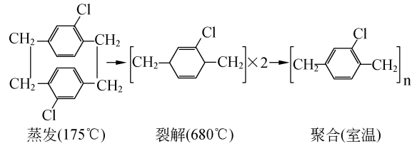
图 2 parylene-C 的化学汽相沉积聚合工艺示意图
